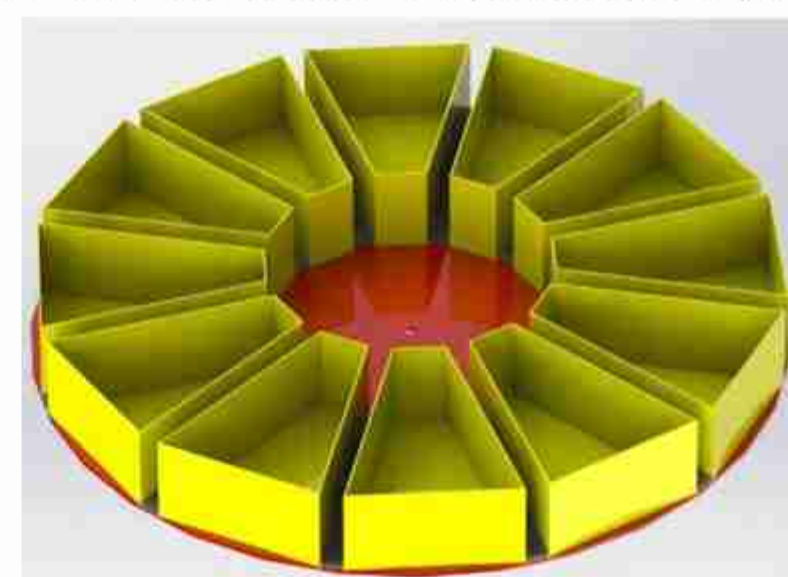
Fig.3 – Carusel cu containere de depozitare a probelor de sol
