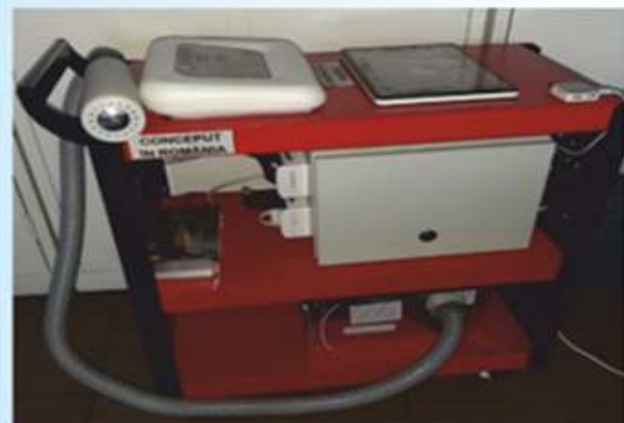
Figura 1: Sistem mecatronic de măsurare Crio-ultrason
